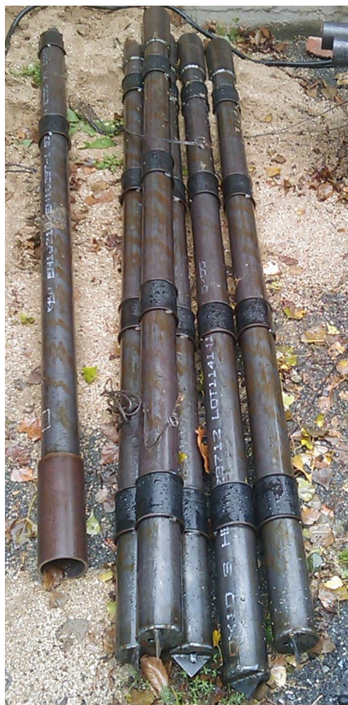
Výztužné trubky mikropilot :
