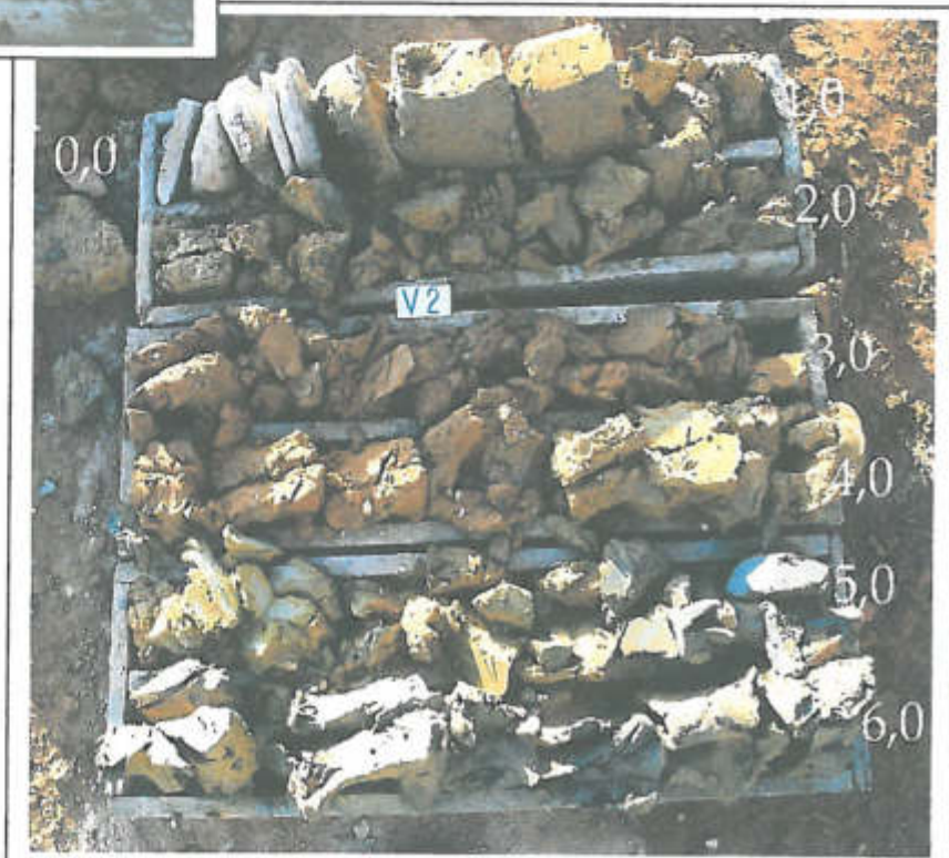
Foto 3 Situace vrtu V2, vrt je umístěn na severní straně projektované stavby SŠUP. Terén v rámci zkoumaného staveniště představuje dlážděná podlaha rovnoměrné a pravidelné výškové úrovně (ca 354,8 m)
