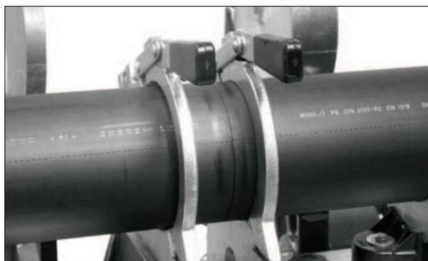
Správně připravené potrubí ke svařování
