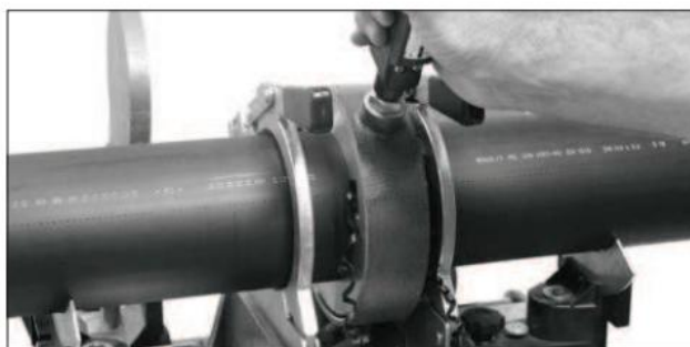
Srovnání konců potrubí integrovaným hoblíkem
