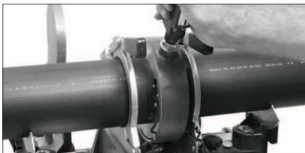
Řez potrubí ruční rotační rezačkou
