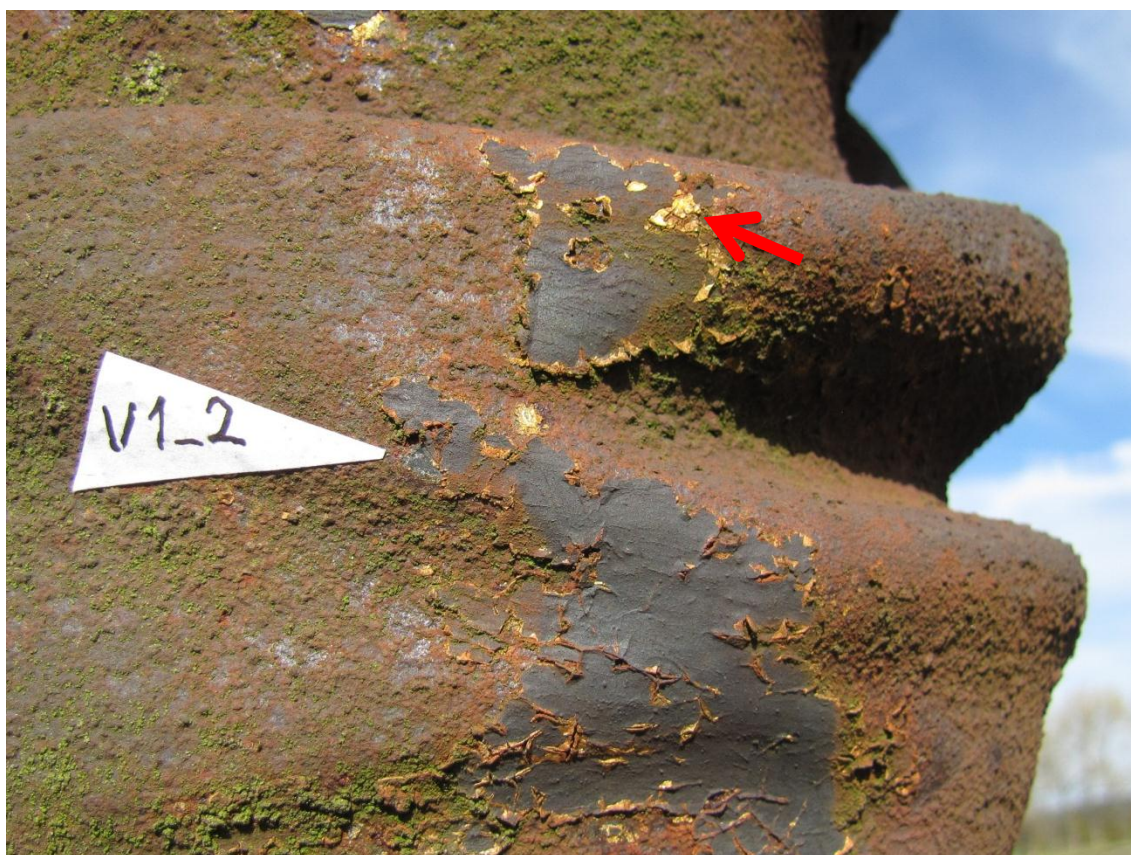
Obr. 12: Místo odběru vzorku z drapérie na pravé noze. Šipkou zvýrazněno zlacení.
