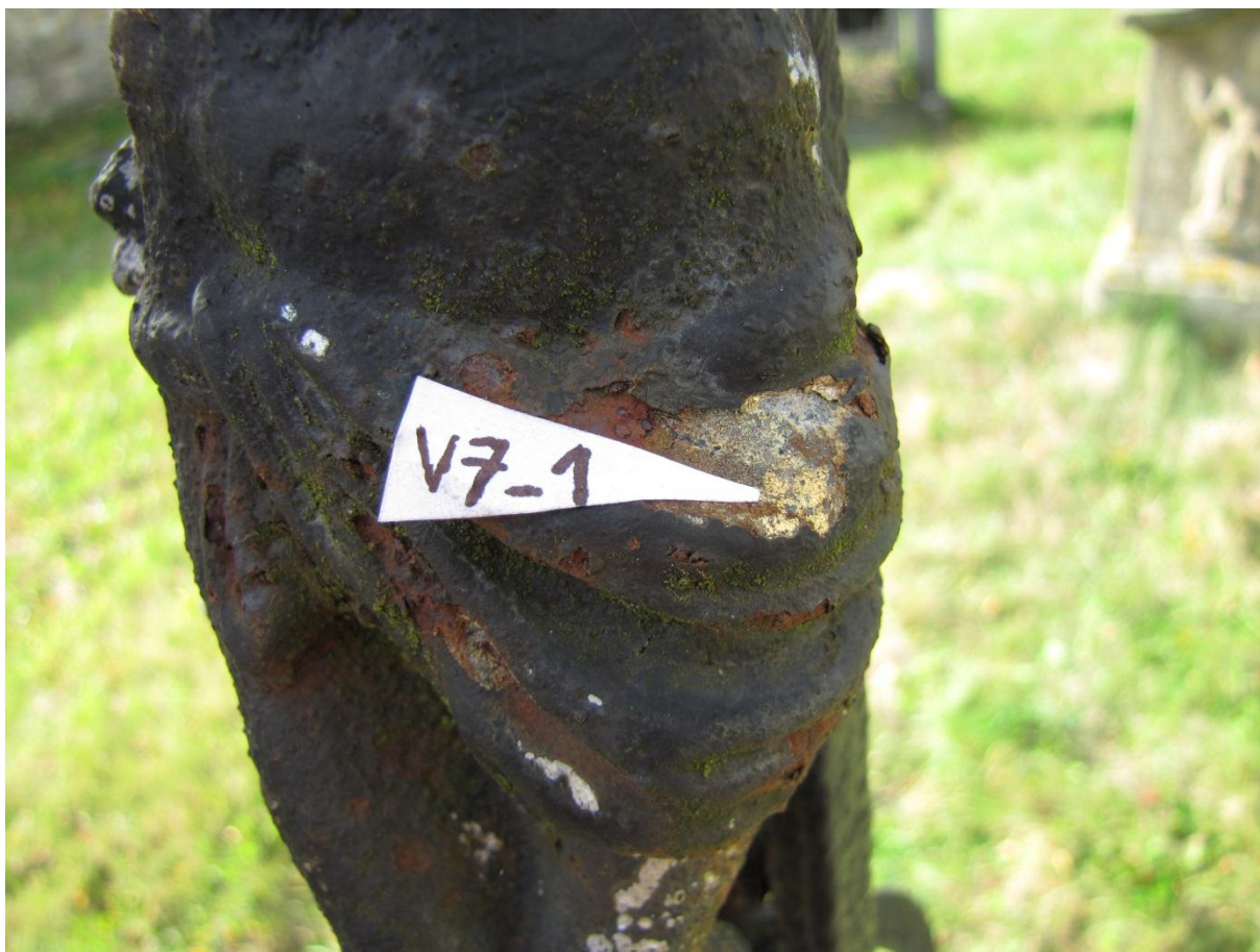
Obr. 41: Místo odběru vzorku se zbytky původního zlacení.
