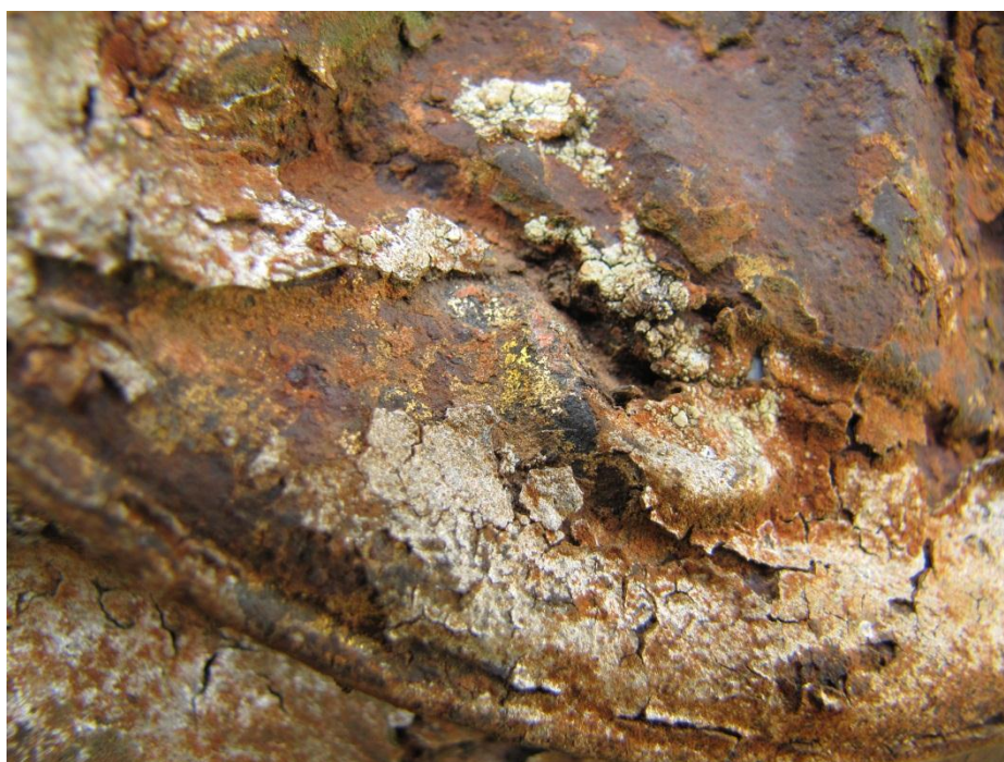
Obr. 19: Degradovaná povrchová úprava, místy prosvítá původní zlacení.
