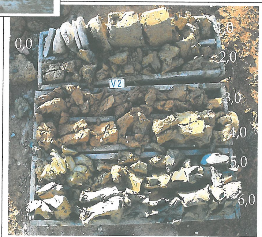
Foto 3 Situace vrtu V2, vrt je umístěna na severní straně projektované stavby SŠUP. Terén v rámci zkoumaného staveniště představuje dlážděná podlaha rovnoměrné a pravidelné výškové úrovně (ca 354,8 m)
