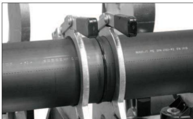
Chladnutí svařeného spoje
