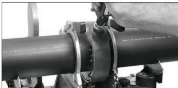
Srovnání konců potrubí integrovaným hoblíkem
