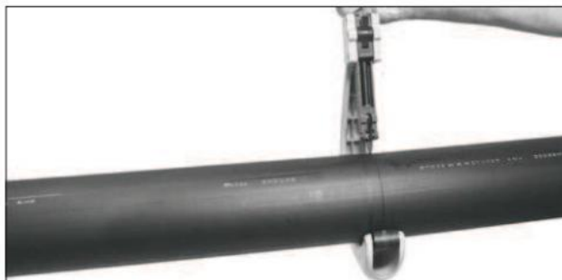
Řez potrubí ruční rotační řezačkou
