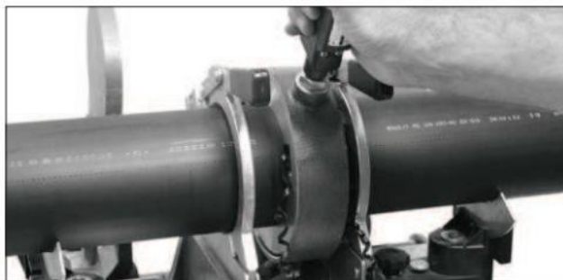
Srovnání konců potrubí integrovaným hoblíkem
