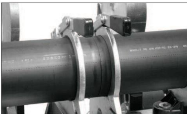
Správně připravené potrubí ke svařování
