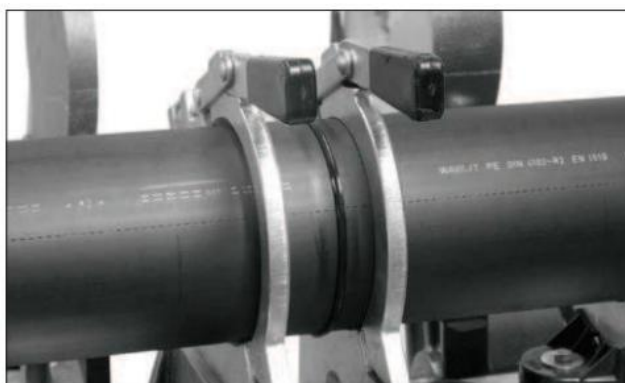
Chladnutí svařeného spoje
