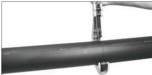
Řez potrubí ruční rotační řezačkou
