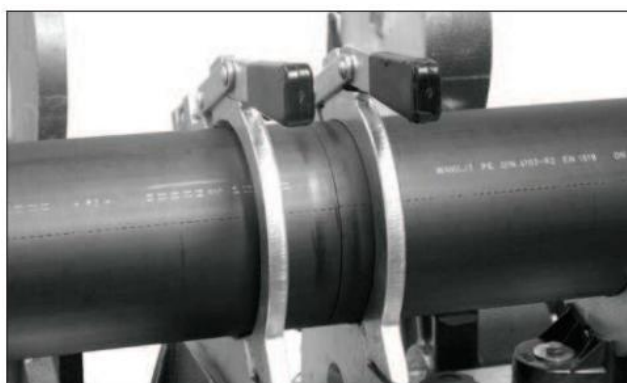
Správně připravené potrubí ke svařování
