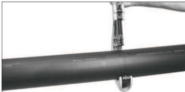
Řez potrubí ruční rotační řezačkou
