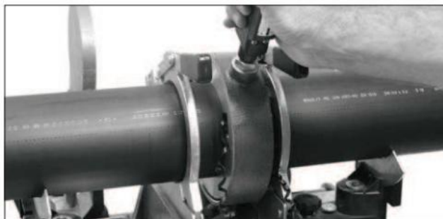
Srovnání konců potrubí integrovaným hoblíkem
