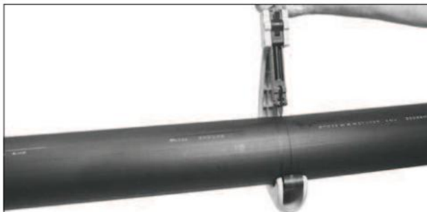
Řez potrubí ruční rotační řezačkou
