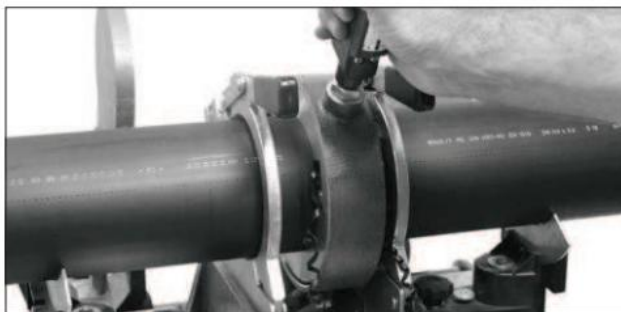
Srovnání konců potrubí integrovaným hoblíkem
