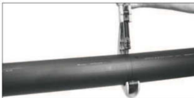
Řez potrubí ruční rotační řezačkou
