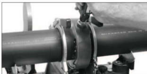
Srovnání konců potrubí integrovaným hoblíkem
