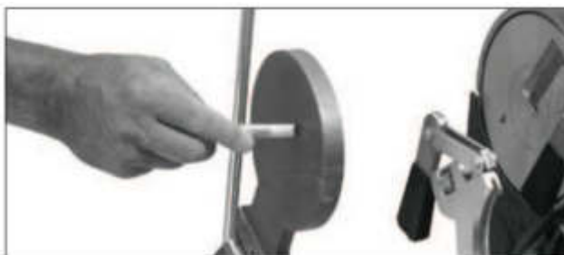
Kontrola teploty svařovacího zrcadla pyrometrem
