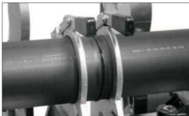
Chladnutí svařeného spoje
