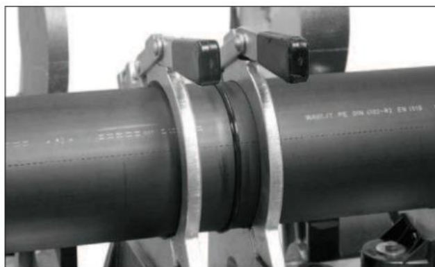
Chladnutí svařeného spoje
