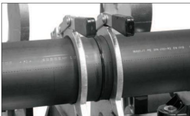
Chladnutí svařeného spoje
