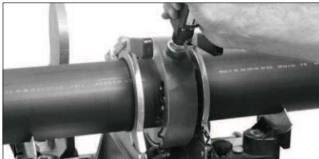
Srovnání konců potrubí integrovaným hoblíkem
