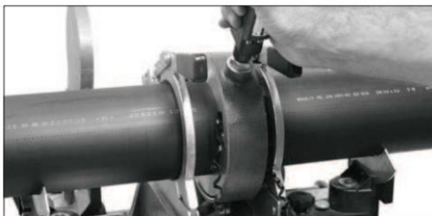
Řez potrubí ruční rotační řezačkou
