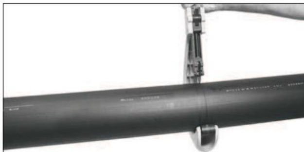
Řez potrubí ruční rotační řezačkou
