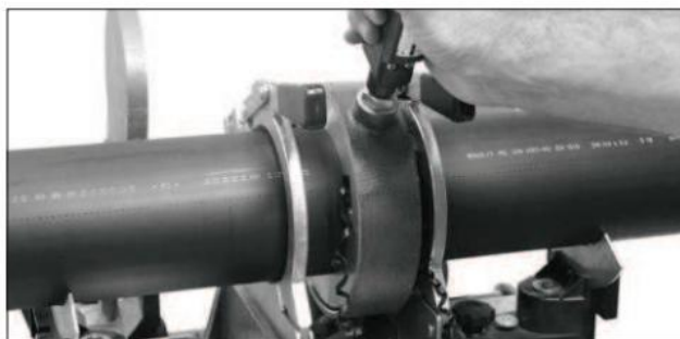
Srovnání konců potrubí integrovaným hoblíkem
